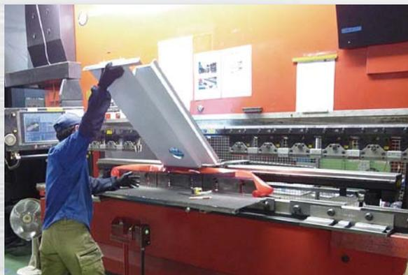
ベンディングマシンHDS-1303NTによる曲げ加工
