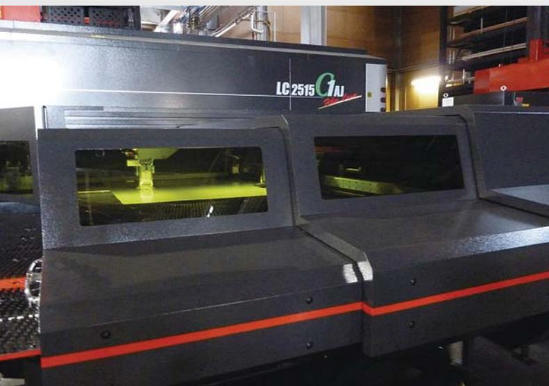
テーブルキャビン方式のカバーがレーザービームの反射光を遮光する
