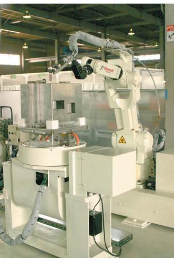
業界初の3DCAD連動の溶接ロボット。アーム部は2mのレール上を移動し加工物固定台も角度が変わる
