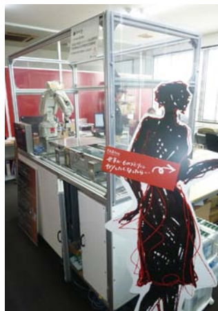
可視検証シミュレーションソフト「SMASH」の検証ができる模擬ライン。製造ラインでの複数制御機器の設計・事前調整などを行うことができる
